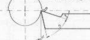
Die Schneidewinkel richtungsrichtig dem zu bearbeitenden Material stellen.
